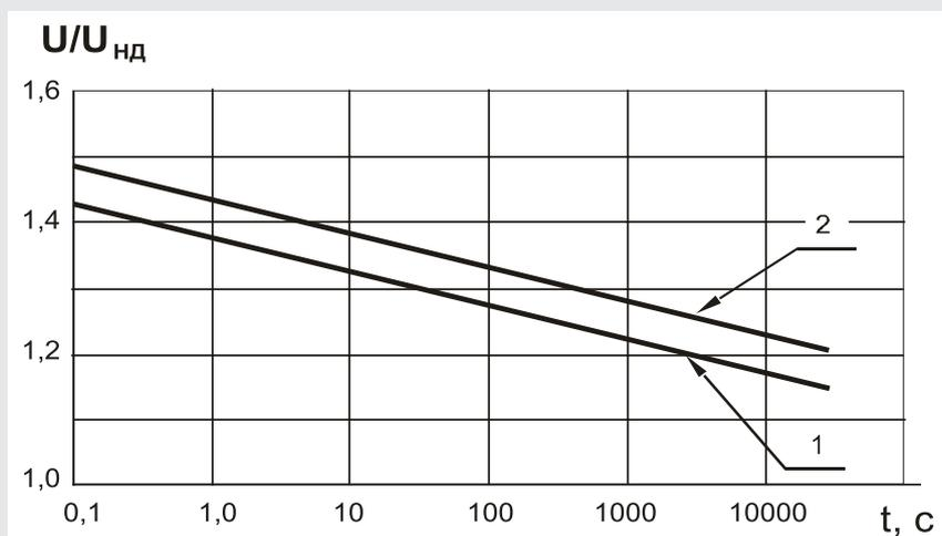
Рис.1. Характеристика «напряжение-время» ограничителей типа ОПН-РВ.
